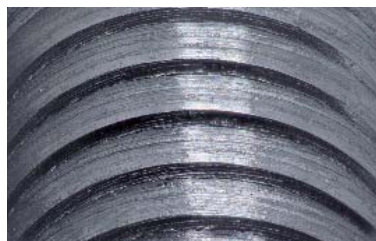
Après avoir taraudé 184 trous avec VUSP CH, la finition de la surface reste excellente.
