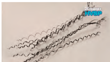
Copeaux éjectés par des tarauds de grande dimension
